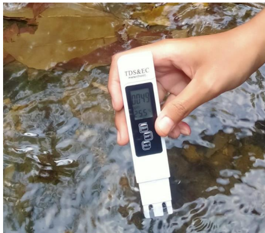
Gambar 3. Hasil Pengukuran zat terlarut dalam air menggunakan TDS meter
