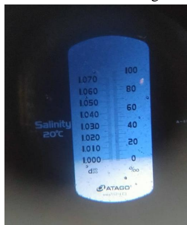
Gambar 4. Hasil pengukuran salinitas air menggunakan refraktometer.
